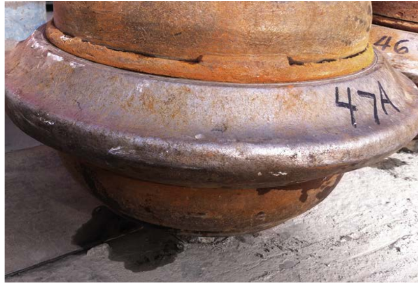
◀ 研磨性地质及高压使得钢材和密封件面临着绝对的负荷界限。
